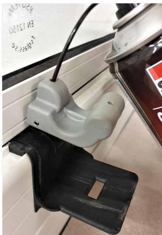
Låsemekanisme dør nede ved gulv
